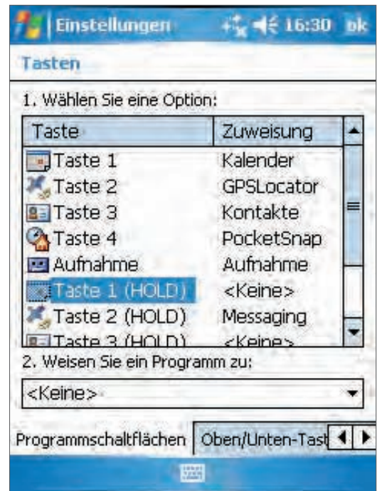
Abbildung 2.3: Über „Einstellungen | Tasten“ kann man die Funktion auf PDA-Ebene ändern.
