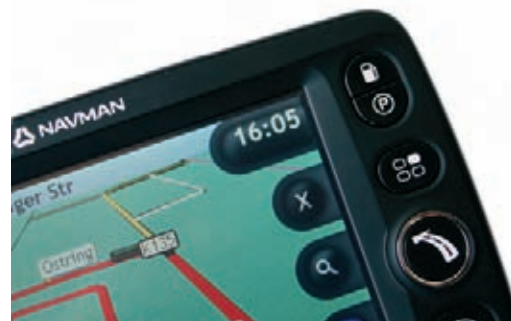
Abbildung 2.4: Auf einem Navigationssystem tummeln sich virtuelle (links) und echte Tasten (rechts).
