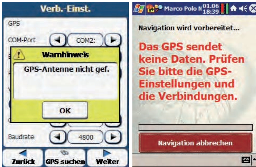
Abbildung 5.8: Die Horrormeldung bei der Installation ist der Warnhinweis des nicht gefundenen GPS-Empfängers (Beispiel: Destinator) oder einer belegten Schnittstelle (Beispiel: Marco Polo).
