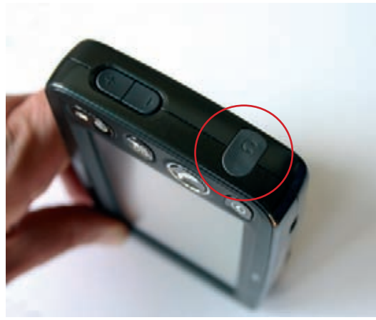
Abbildung 2.1: Fast alle Navigationsgeräte verfügen über einen Kopfhöreranschluss (hier hinter einer Gummilasche), um das Gerät extern anschließen zu können.
