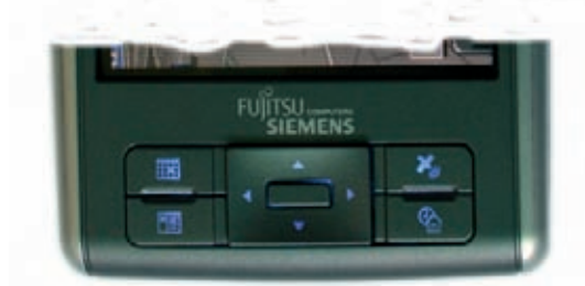
Abbildung 2.2: Über dieses Bedienfeld verfügen praktisch alle Pocket PCs, es ist nur unterschiedlich gestaltet. (Beispiel: Fujitsu-Siemens PocketLOOX N520)
